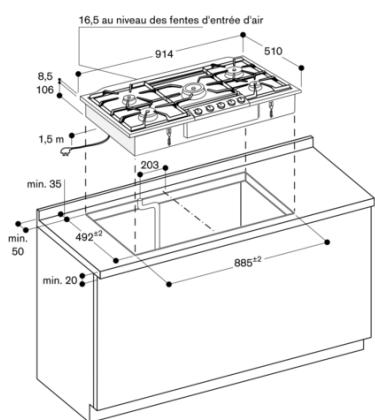
Distance minimale entre la découpe de l'appareil et la paroi latérale 300 mm.
