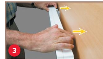
3 Enclencher le plateau sur les équerres pliantes en le poussant vers le mur support et relâcher la pression sur le bord. Le plateau est fixé.
