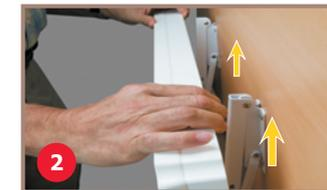
2 Approcher la partie supérieure du plateau vers les équerres pliantes, en tirant légèrement sur le bord supérieur du plateau au droit des 2 lignes en relief.
