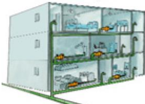
Installation dans un bâtiment à dérivations multiples
