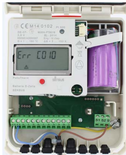
Figure 10 : Capteur de débit raccordé sur le PolluTherm
