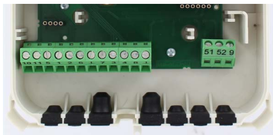
Figure 8 : Ouverture du couvercle avec un passe-câble sorti de son logement
