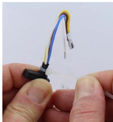
Figure 9 : Serrage du câble avec attache-câbles
