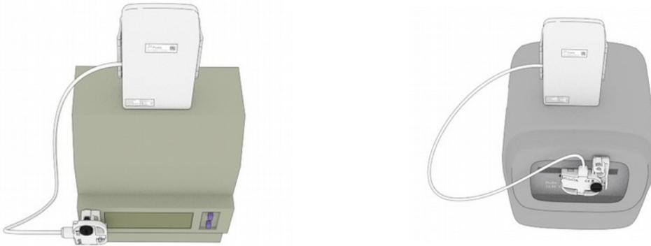
Raccordez le lecteur optique au boîtier radio à l'aide du câble micro-USB fourni.
