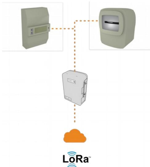
Les FM432e et FM232e sont des capteurs d'électricité communicants qui utilisent les protocoles LoRaWAN (FM432e) et LoRa Point à Point (FM232e) pour transmettre les données de consommation. Ils sont composés d'un boîtier radio et d'un lecteur optique.
