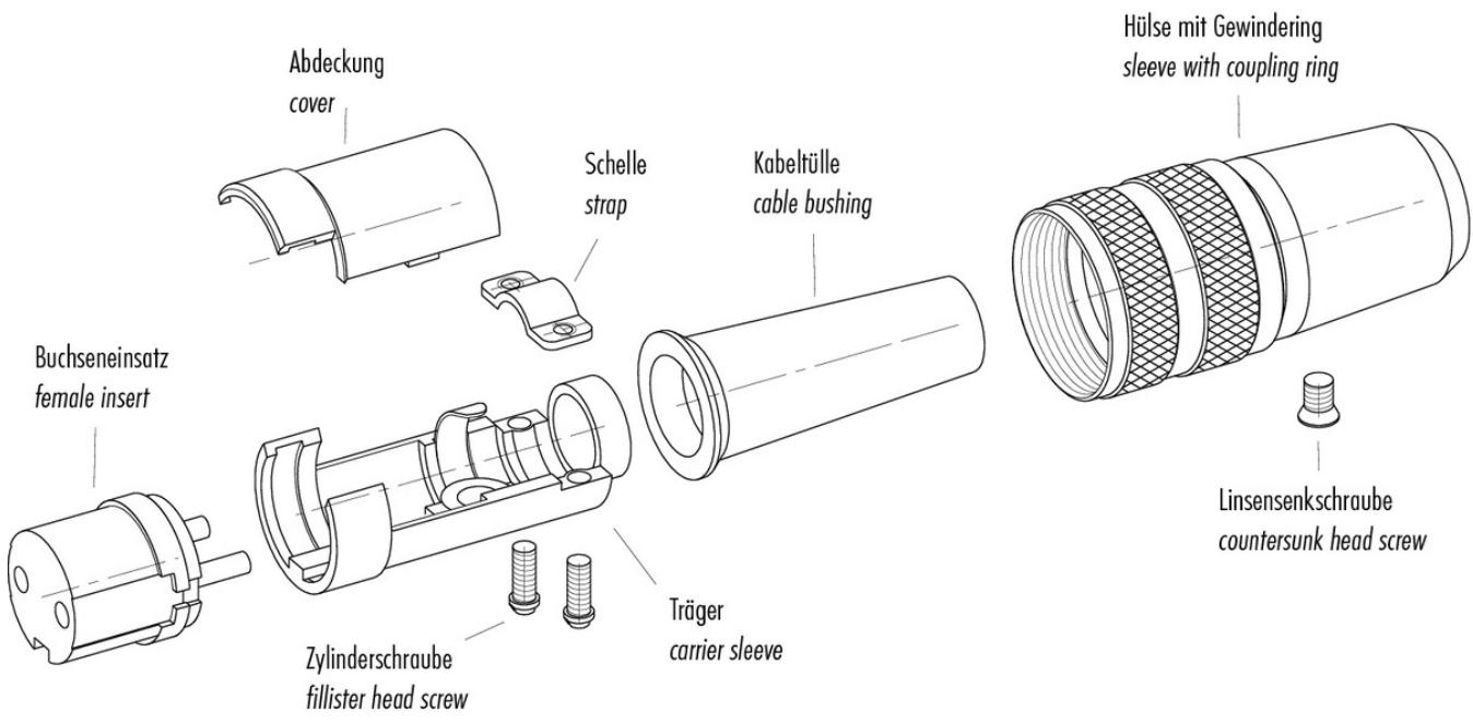
Description du produit **Contacts: 3 DIN, connecteur femelle, passage de câble 3 – 6 mm, contacts argentés**
