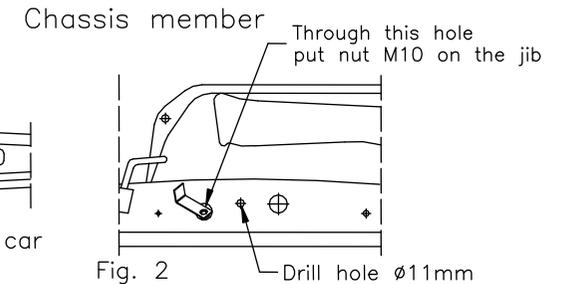
Fig. 2 Drill hole  $\varnothing 11$ mm
